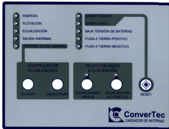
Figura 1: Panel de señalización Cargador de Baterías.
